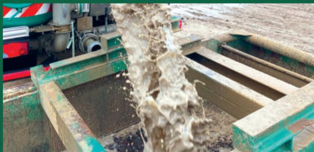
**2** Danach werden größere Feststoffe, also Partikel über 90 Mikrometer (das entspricht ungefähr dem Durchmesser eines menschlichen Haars), mithilfe eines Rüttelsiebs und sogenannten Hydrozyklonen abgeschieden. Dabei entsteht hauptsächlich Sand und eine sandfreie Bohrspülung.
