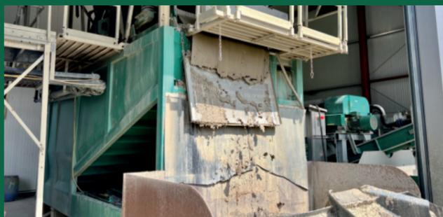
**3** Um die restlichen festen Stoffe herauszuholen, wird ein Flockungsmittel zugesetzt. Dann trennt eine Dekanterzentrifuge, bei 3000 Umdrehungen pro Minute, mit starker Drehkraft Wasser und Feststoffe. Am Ende bleiben klares Wasser (Zentrat) und ein dicker Schlamm – der sogenannte Dickschlamm oder Subbentonit.
