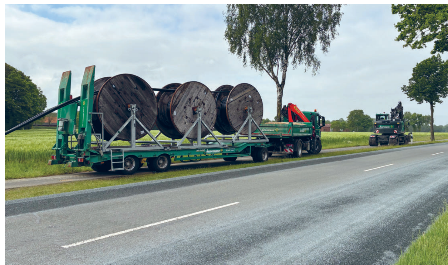
Kabeleinzug mit dem Spezialtieflader
